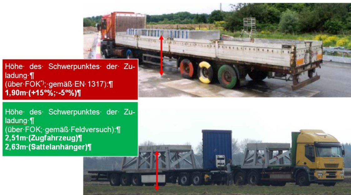
Bild 19: Konventionelles 38t-Sattelkraftfahrzeug (oben) und Lang-Lkw Typ 3 (unten) als Prüffahrzeuge im Vergleich
